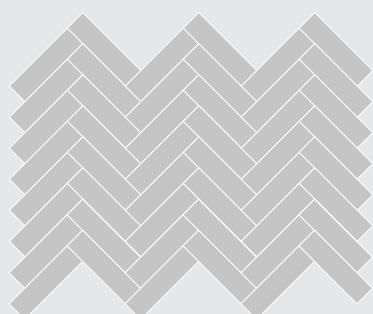
POSE A BÂTONS ROMPUS (HERRINGBONES)
