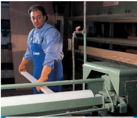
Application au rouleau d'Adesivil D3 pour assemblage d'éléments en bois
